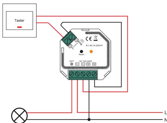
\* Ausgangsleistung bei LED bzw. LED Treiber: 200W, Ausgangsleistung bei Halogenlampen: 400W
